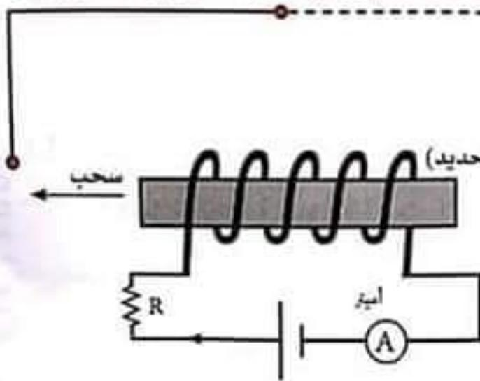
(٤) في الشكل المقابل ملف بداخله قلب من الحديد والملف متصل مع مقاومة أومية وأميتروبطارية على التوالي في دائرة كهربائية مغلقة. ماذا يحدث لقراءة الأميتر عند سحب القلب الحديدي من الملف بسرعة؟
